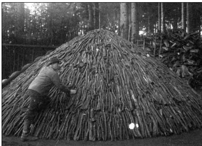
Wypał węgla drzewnego – układanie mielerza – bardzo dokładnie dopasowywano polana przy wykończeniu mielerza.
