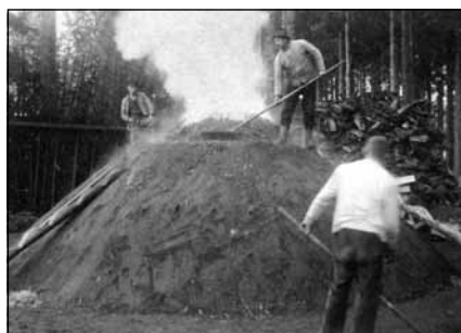
Wypał węgla drzewnego – mielerz okryty oponą wykończoną świerkowymi gałkami zaczyna gadać.
